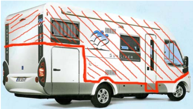
Abbildung 10: Kennzeichnung des untersuchten/gedämmten Innenbereichs des Wohnmobiles
